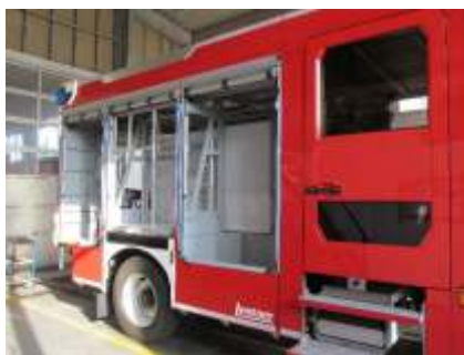
LF 10 mit neu konzipierten Auxilium-Aufbau
